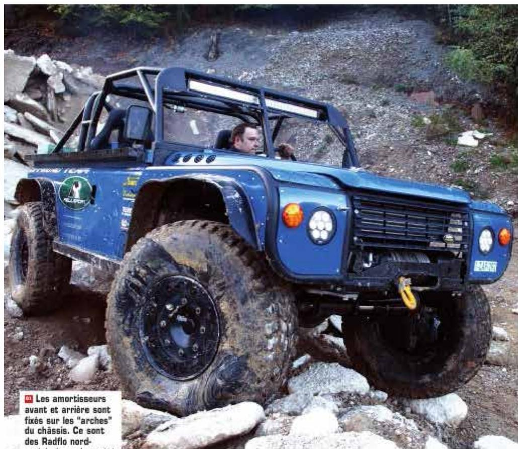
01 Les amortisseurs avant et arrière sont fixés sur les "arches" du châssis. Ce sont des Radflo nord-américains qui ont été fortement modifiés au niveau des pistons et des clapets.
