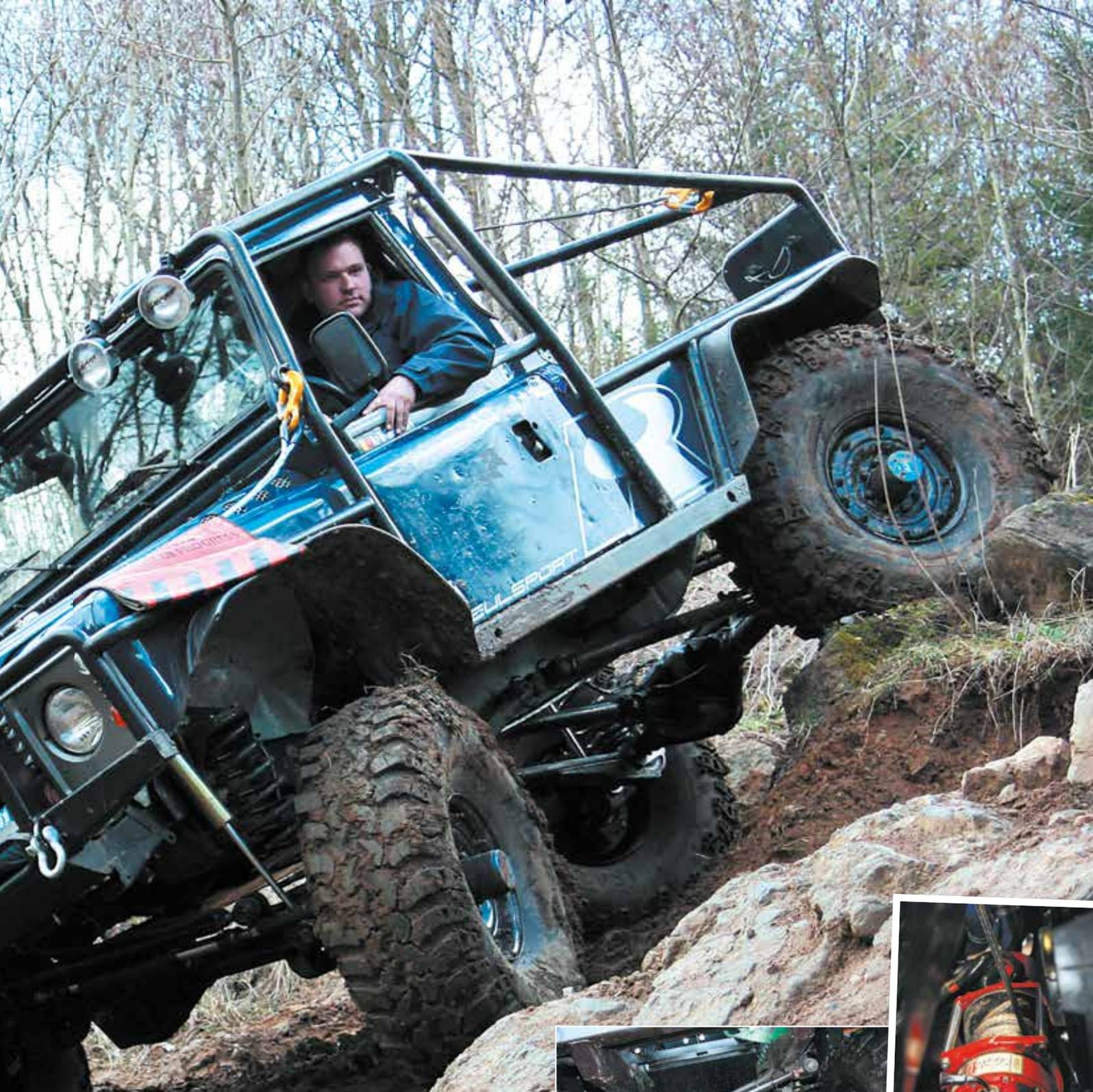
**01** La télécommande manipulée par Benoît contrôle à la fois les treuils avant, arrière et la direction arrière.
