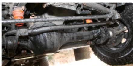
La nouvelle face du carter de pont en Hardox permet à la fois de gagner en résistance et en garde au sol, grâce à sa base plate.
