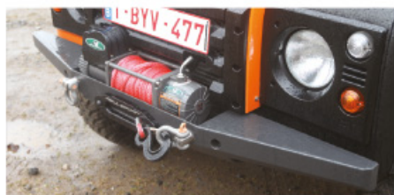
L'avant du véhicule a été rééquipé en accessoires Reul Sport : treuil électrique 9500 à corde synthétique, pare-chocs et ski de protection.
