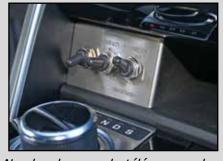
Ne cherchez pas la télécommande du treuil Red Winch! Benoît et Antoine le contrôlent avec ces trois interrupteurs (mise sous tension, enroulement, freespool).
